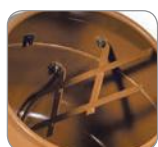
Duas pás-misturadoras de fácil substituição
